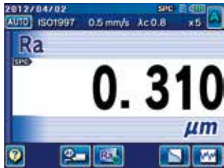
1-parameter display: one parameter measurement result
